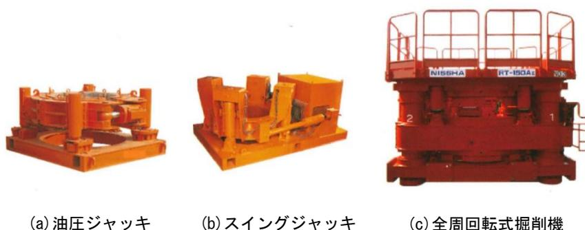
写真 4.2.1 ケーシング建込み機械<sup>4.2.2)</sup>
